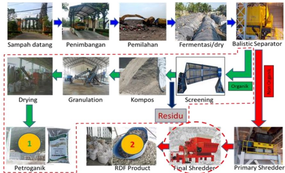
Gambar 3.14 Alur proses produksi RDF di Pilot Project Ngipik, Gresik Sumber: Semen Indonesia, 2019
