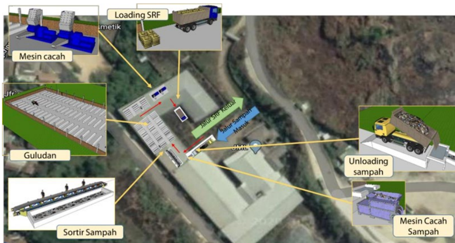
Gambar 3.31 Rencana tata letak RDF dalam Skema Citarum Harum (1) Sumber: PUPR, foto dokumentasi PT Indonesia Power 2021
