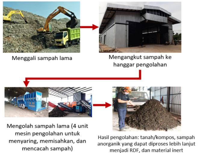
Terdapat 2 alur pemrosesan sampah untuk Landfill Mining di TPST Bantargebang dengan perbedaan pada proses pencacahan. Alur pertama menggunakan mekanisme pemilahan dengan trommel dan selanjutnya dicacah. Sementara, untuk alur kedua menggunakan pemilahan dengan trommel dan wind shifter yang menghasilkan RDF yang tidak tercacah. Teknologi pengolahan tersebut termasuk ke dalam kategori *mechanical treatment* (MT).
